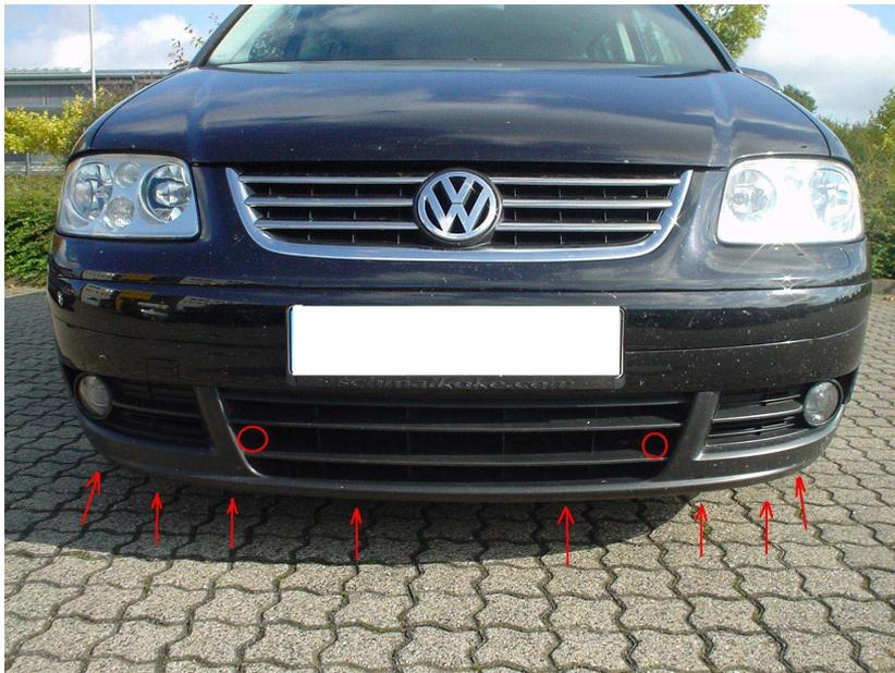
Die Stoßstange jetzt nach vorn abziehen und vor das Fahrzeug legen. Die Kabel für die Nebelscheinwerfer und die eventuell vorhandenen Schläuche für die Scheinwerferreinigungsanlage brauchen nicht abgezogen zu werden.
