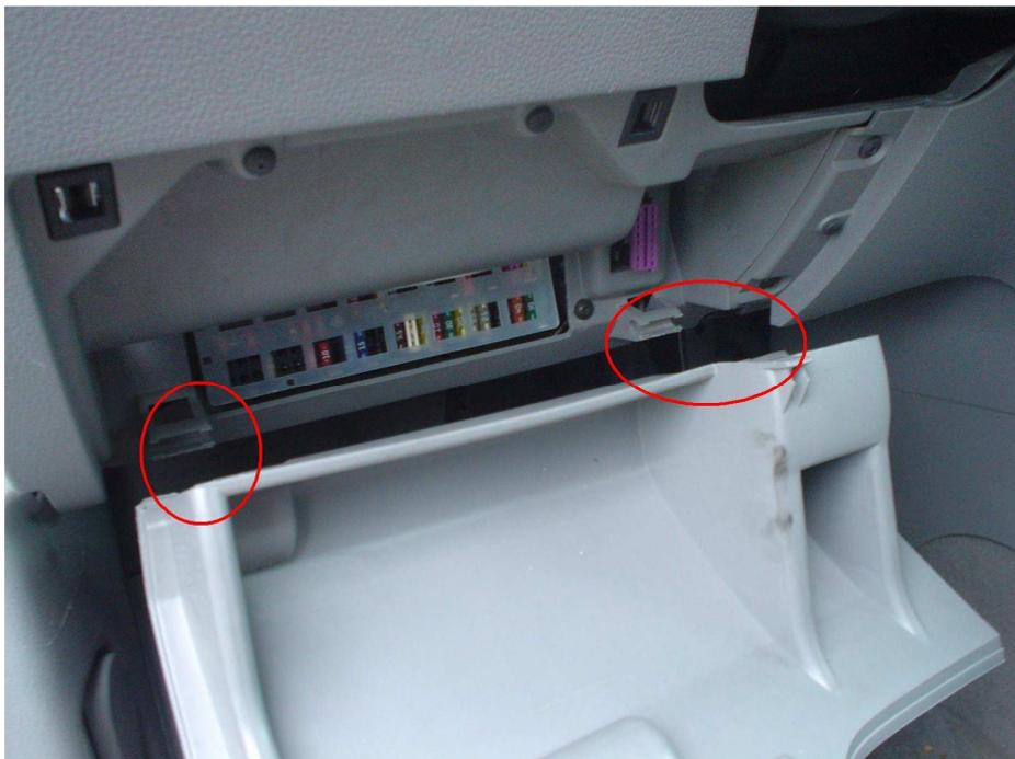
Seitliche Verkleidung abhebeln und die Torx-Schraube entfernen.
