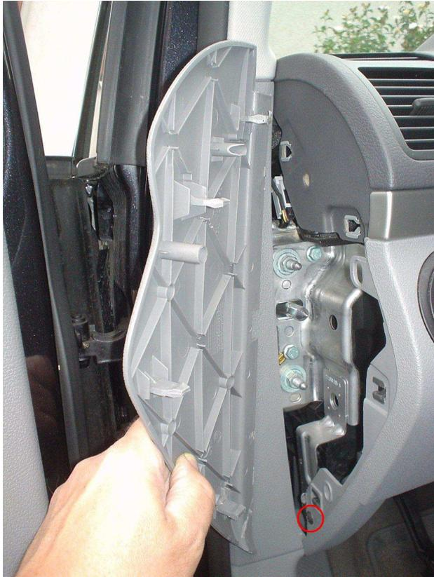
Verkleidung unterhalb des Lenkrads ausbauen, hierzu Torx-Schrauben entfernen,
