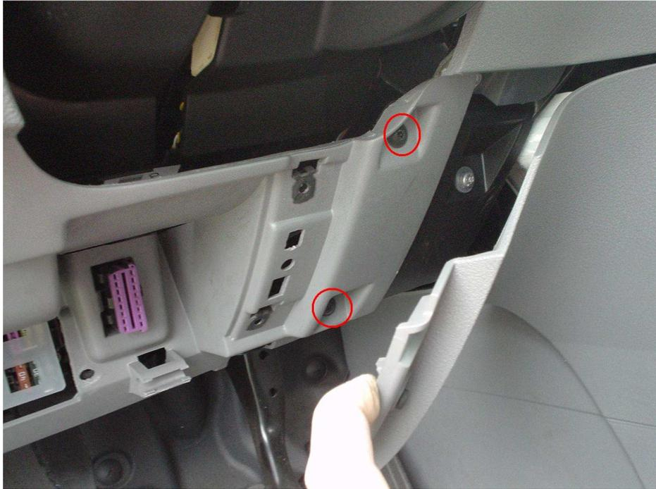
und Verkleidungsteil an der Oberkante ausrasten, Kabelstecker vom Lichtschalter und der Leuchtweitenregulierung abziehen, OBD-Buchse ausrasten.
