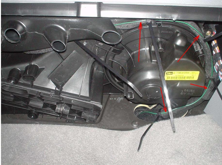
Die Verlegung des gelben Kabels vom Innenraum zum Zuheizer erfolgt am einfachsten durch die Kabeldurchführung in der Spritzwand hinter dem ABS-Steuergerät. Nun den zuvor beschriebenen Draht, mit viel Gefühl, neben dem Kabelbaum durch die Gummitülle bis in den Motorraum schieben.
