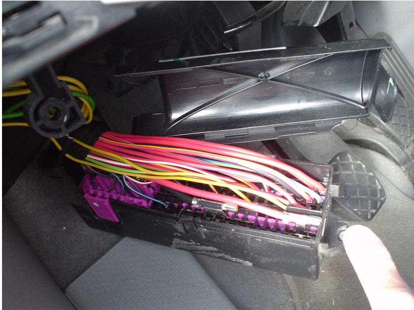
Die Verkleidung unterhalb des Handschuhfachs entfernen, hierzu die beiden Kunststoffschrauben mit der Hand herausdrehen, sowie an beiden Seiten die Verkleidungen der Mittelkonsole ausbauen, durch abziehen und nach vorn schieben.
