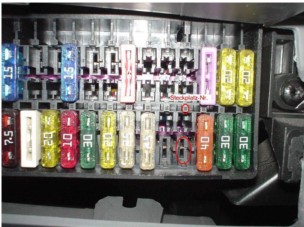
Bei Fahrzeugen bei denen diese Kontakte nicht vorhanden sind kann das Herstellen der Spannungsversorgung mit „Stromdieben“ durch aufklebmen auf eine Leitung eines Sicherungsplatz der das benötigte Spannungspotential führt, z.B. Nr. 28 für Zündungsplus und Nr.47 für Dauerplus, erfolgen.
