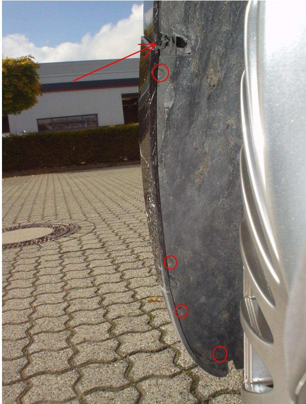
Im mit dem Pfeil markierten Bereich befindet sich zur Verbindung von Stoßfänger und Kotflügel ein Spreizdübel, zum entfernen den Stößel mit einem spitzen Werkzeug herausdrücken.
