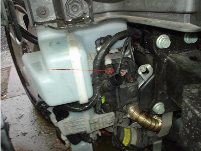
Das weiße und schwarze Kabel des Leitungsstrangs muss in die Steuerleitung zum Frischluftgebläse eingebunden werden. Hierzu nach lösen der Verriegelung die Einheit drehen und herausnehmen.
