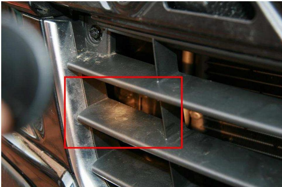
Nun kann der Stoßfänger wie bei den älteren Modellen nach vorn abgezogen werden
