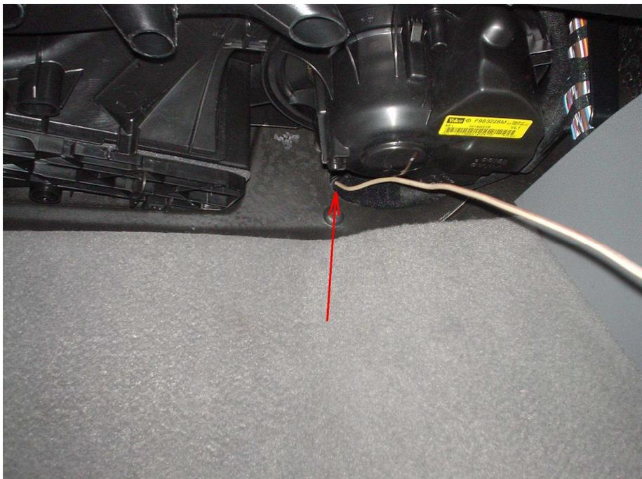
Kabel mit Isolierband am Draht befestigen, hierbei den aufgerimpten Steckkontakt komplett mit dem Isolierband umwickeln, und in den Motorraum ziehen.
